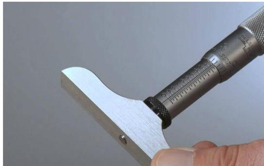
Este instrumento de medición se compone de una base templada, rectificada y pulida, combinada con una cabeza micrométrica. Los vástagos se introducen a través de un agujero existente en el husillo micrométrico, y se colocan en la posición correcta por medio de una tuerca estriada.
