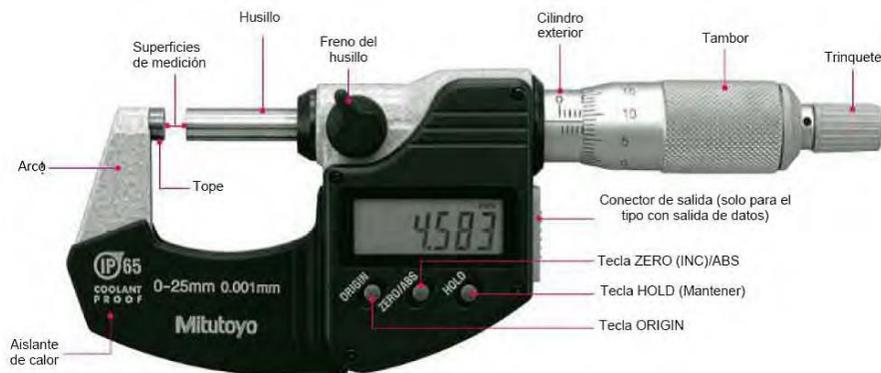
Los micrómetros digitales electrónicos usualmente están provistos de algunas funciones que facilitan el proceso de medición y análisis de datos, tales como el poner a cero solo oprimir una tecla, la posibilidad de obtener lecturas en milímetros o en pulgadas, mantener en pantalla un valor y la salida de datos a un procesador, un multiplexor o una PC
