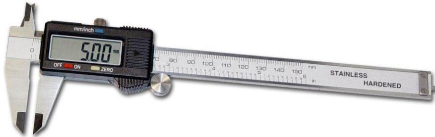
La figura anterior muestra un calibrador electro-digital que consiste de un brazo principal como en el calibrador vernier convencional, y una unidad de escala de desplazamiento y una unidad de lectura.
