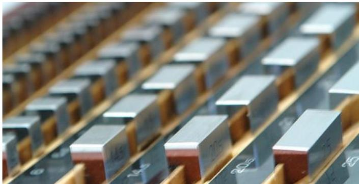
Generalmente se presentan por juegos de un número variable de piezas y gracias al fino acabado de sus caras de medida se pueden adherir entre sí mediante un simple deslizamiento manual,
