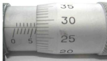
El micrómetro es un dispositivo ampliamente usado en ingeniería mecánica, para medir con precisión el espesor de bloques, medidas internas y externas de ejes, y profundidades de ranuras.
