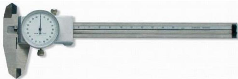
Los calibradores de carátula se utilizan en muchos tipos de trabajos de servicio. Son particularmente útiles para determinar el descentramiento en ejes y rotores. El descentramiento es la variación de movimiento de lado a lado cuando se hace girar un componente.
