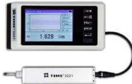
Rugosímetro: Palpador capacitivo. El desplazamiento vertical del palpador aproxima las dos láminas de un condensador, modificando su capacidad y con ella la señal eléctrica.
