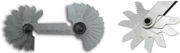
Para usar esta galga simplemente apoyamos sucesivamente cada lámina contra los hilos de la rosca hasta encontrar la que coincida perfectamente en los hilos sin presentar holguras (ver figura de abajo) y seguidamente leemos el número en esa lámina. Ese será el paso de la rosca que, si se trata de una galga métrica nos informará el valor del paso en milímetros, y si es una galga que responde al Sistema Inglés nos informará el paso en hilos por pulgada.
