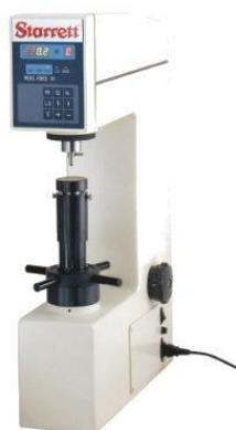
Existen distintos tipos de durómetros de acuerdo a las diversas familias de materiales, habiendo posibilidad de medir dureza tanto a un caucho como a un acero. Si bien la palabra “durómetro” en el mundo anglosajón sólo se emplea para denominar al equipo para medir dureza Shore, en
