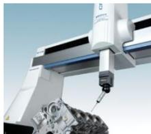
La extracción de la geometría de piezas se hace mediante: punto, línea, plano, círculo, cilindro, cono, esfera y toroide; y con estos elementos puede hacerse la medición completa de una pieza.
