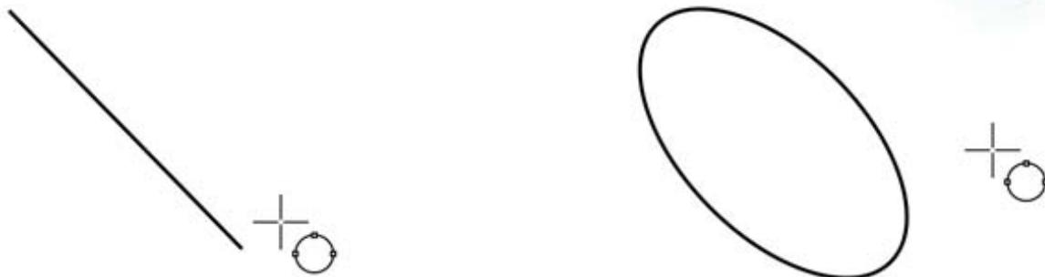
*Por medio de la herramienta **Elipse de 3 puntos** puedes dibujar una elipse, dibujando primero su línea centrada y a continuación su altura.*
