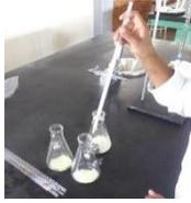
3. Toma una muestra representativa y realiza los análisis de plataforma: organoléptico, densidad, acidez titulable, pH, prueba de alcohol al 72%, almidón.
