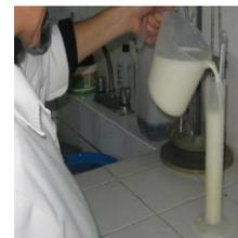
La muestra debe de ser tomada cuando el estanque este lleno y después de haber sido agitado, se toman 100 ml. en un período de los primeros 30 min. El agitador puede ser mecanizado (hélice) o manual. La muestra puede ser tomada con una pipeta metálica que llegue al fondo del tanque y esta debe estar sanitizada.
