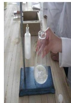
$$\% \text{ \u00c1cido l\u00e1ctico} = \frac{\text{ml NaOH gastado} \times 0.1 \times 0.09}{\text{ml muestra}} \times 100$$
